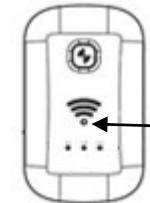
5. Sobald der Punkt dauerhaft leuchtet ist die Verbindung im Gange. Dies kann bis zu zwei Minuten dauern.
